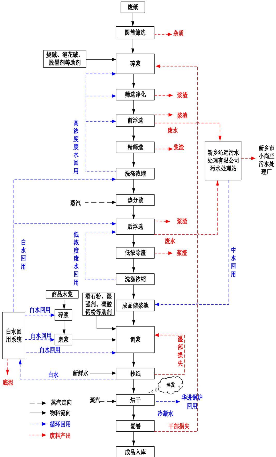
图3-1 生产工艺流程及产污环节示意图
