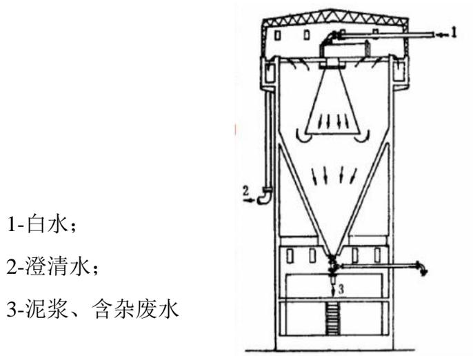
图 6-1 白水处理系统流程示意图
