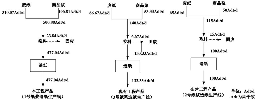
图 0-10 本工程完成后全厂浆料平衡图
