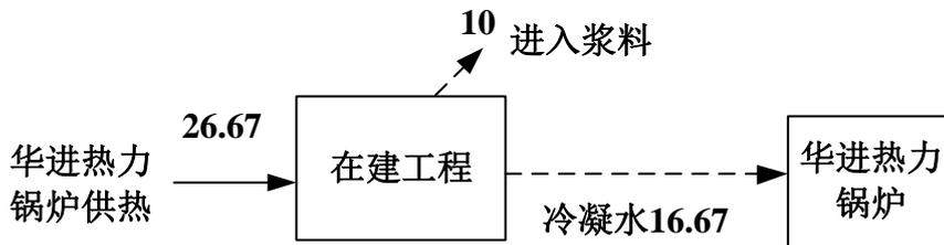
图 3-4 现有工程蒸汽平衡示意图 单位: t/h
