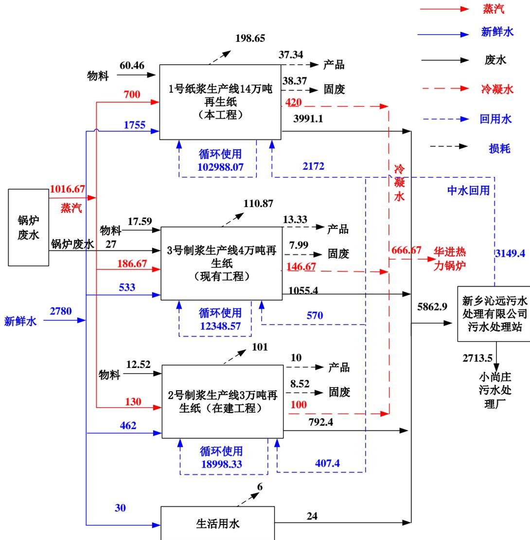
图 3-13 全厂水平衡图 单位: t/d
