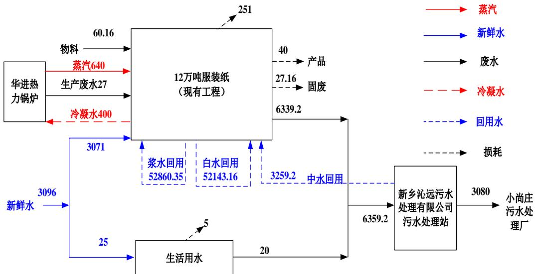
图 3-3 现有工程水平衡图 (单位:  $m^3/d$ )
