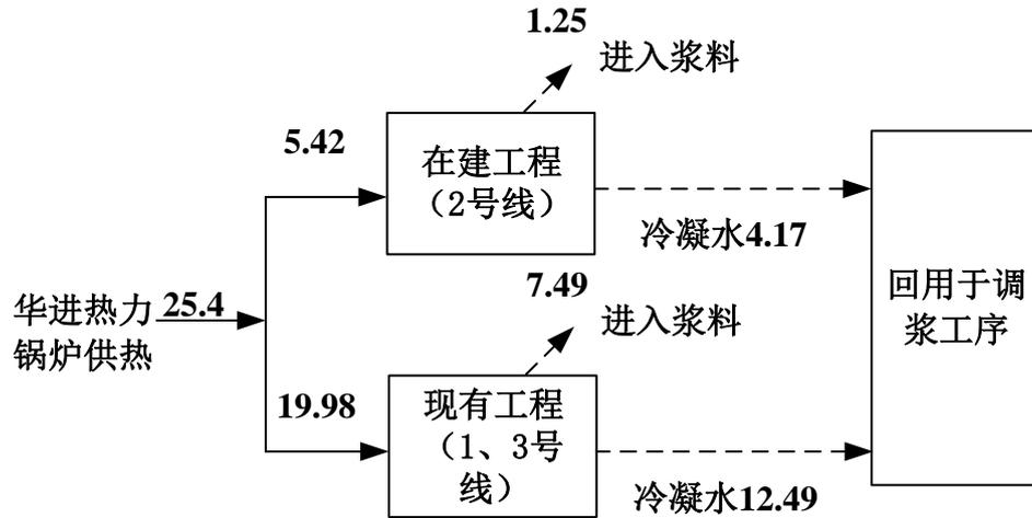
图 3-8 在建工程完成后全厂蒸汽平衡示意图 单位: t/h
