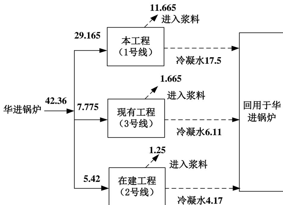
图 3-14 项目完成后全厂蒸汽平衡示意图 单位: t/h
