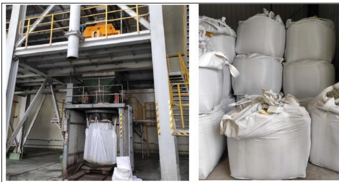
图 3.1-1 飞灰螯合物吨袋实装图
