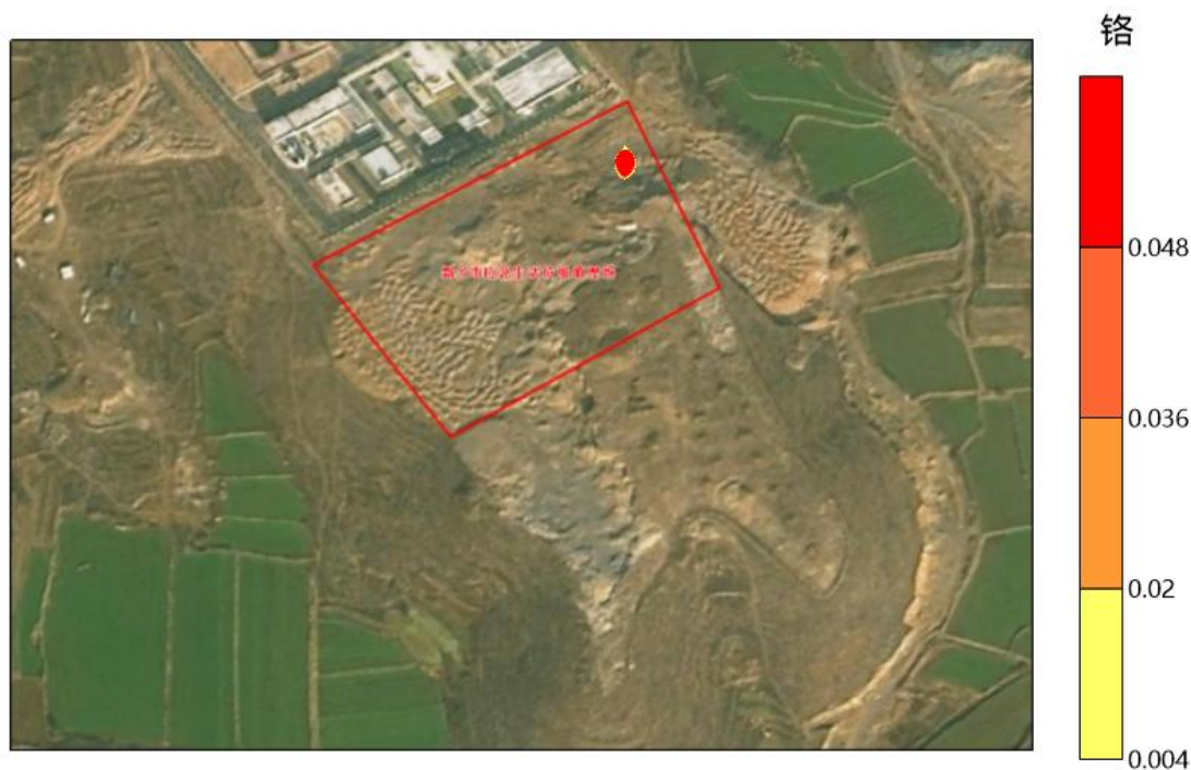
图 5.6-24 泄漏 100 天后地下水铬污染分布图
