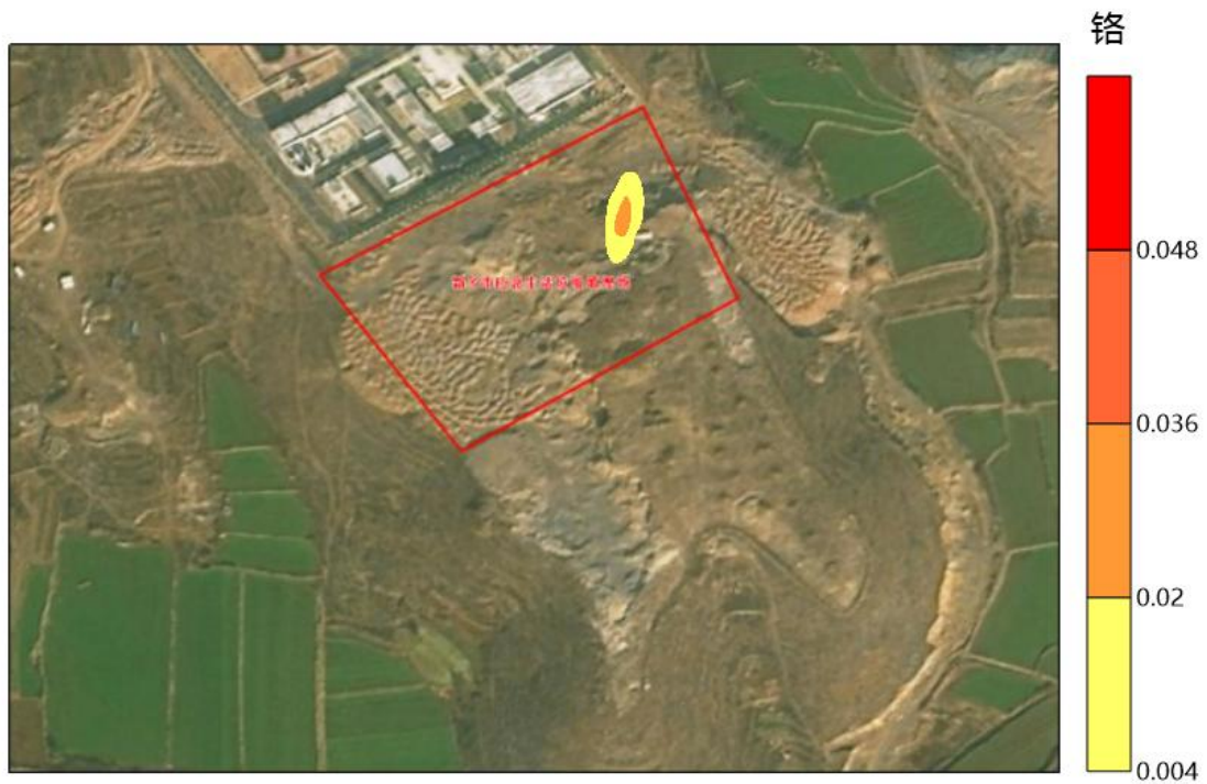
图 5.6-26 泄漏 3650 天后地下水铬污染分布图
