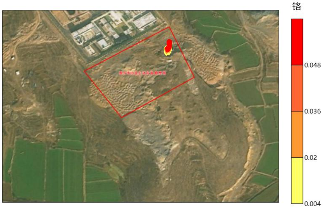
图 5.6-25 泄漏 1000 天后地下水铬污染分布图
