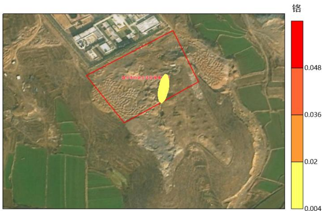
图 5.6-27 泄漏 7300 天后地下水铬污染分布图
