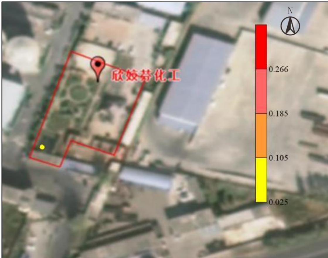
图5.3-31 7300 天污染晕迁移分布图（氨氮）
