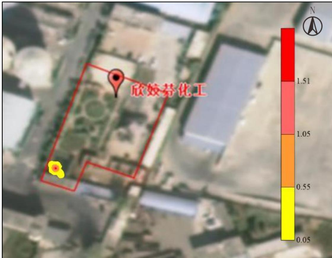
图5.3-24 100 天污染晕迁移分布图（耗氧量）
