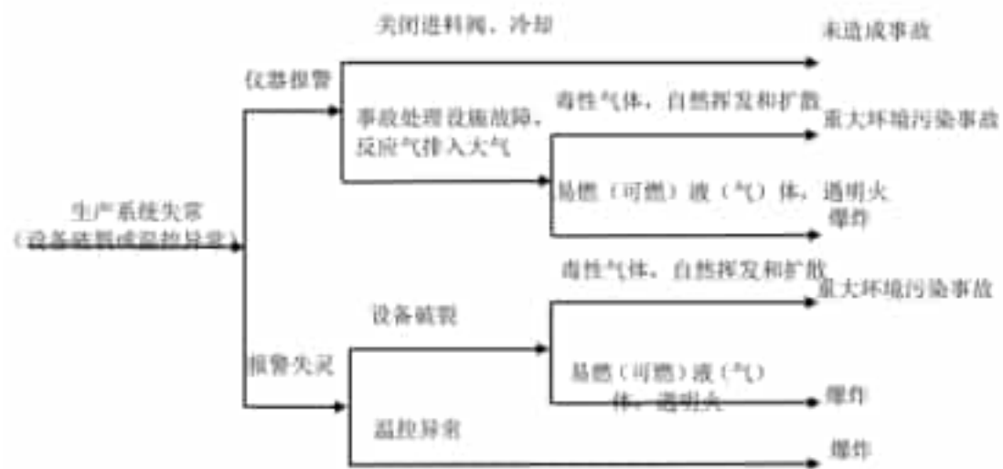
图 6.2-3 生产系统事件树示意图
