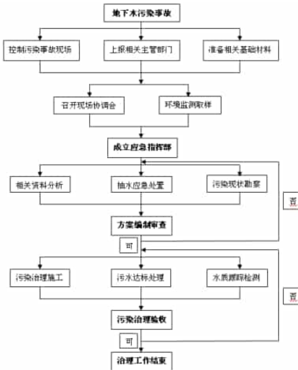
图 5.6-35 地下水污染应急治理程序框图
