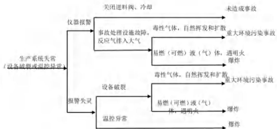
图 5-26 生产系统事件树示意图
