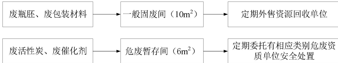
图 7 固废处理流程示意图
